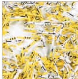
Sicherheitsstufe 5 · Partikel Zerkleinerung Nr. 8 0,78 x 11 mm
